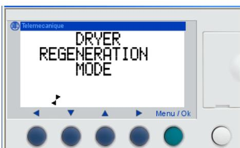
Восстановление осушителя автоматически включается на 10 минут после 24 часов непрерывной работы компрессора.
