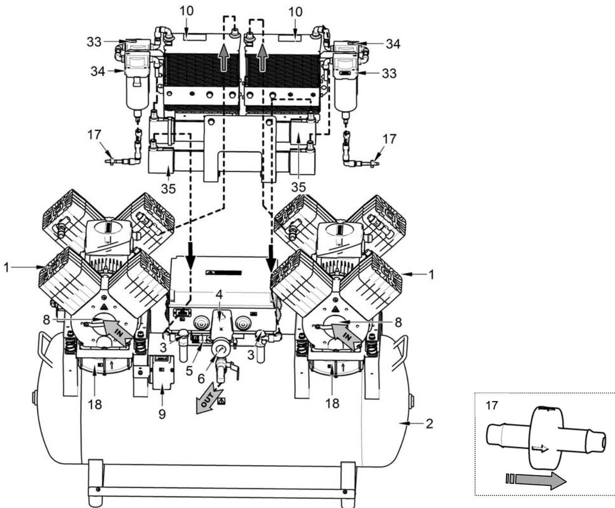
Рис.3- Компрессор с адсорбционным осушителем NDM
