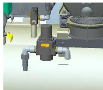
**Система автоматического слива конденсата / блок 604011998-000 /**
